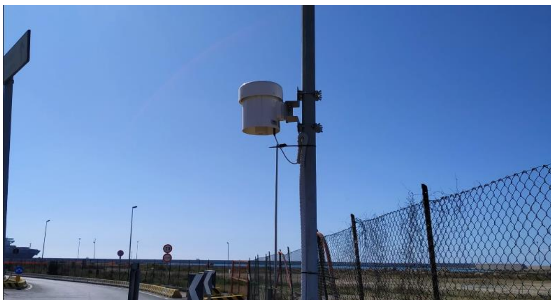
Figura 7: Campionatore a flusso 0.5 l/min (in alto) e a flusso 2 l/min (in basso) installati nella zona portuale di Civitavecchia.
